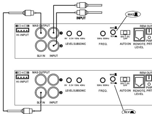
**VORSICHT:** Das Zusammenschalten von zwei ECS 1200.1 -Verstärkern wird nicht für Impedanzlasten unter 2 Ohm empfohlen.
