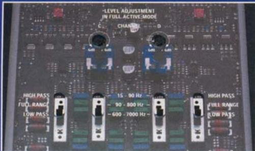
**Features II:** Über diese vier Schalter lassen sich der Frequenzbereich und die Filter einstellen.
