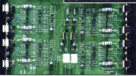
Kleinteile: Durch den Einsatz von SMD-Bauteilen fallen die DLS-Amps ziemlich kompakt aus.
