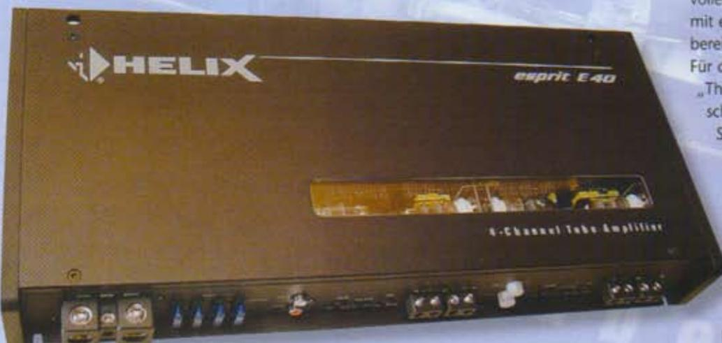
Um diese neue Ära zu unterstreichen begehrt die deutsche Ideenschmiede gleich einen Traditionsbruch: Die Anschlüsse sind nun nicht mehr an den Enden sondern an einer Längsseite. Hervorstechend ist natürlich die Röhrenvorstufe. Um dieses Feature auch optisch in Szene zu setzen sitzen die Tubes unter einem Ausschnitt und werden von orangefarbenen LEDs durchleuchtet. Der eingeschaltete Zustand des Amps ist dann nicht mehr zu übersehen.
