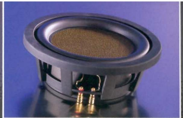
**Sandwich:** Die Flachmembran besteht aus einem Honigwabens-Alu-Kern, der mit einem Kevlar-/Kohlefasergewebe abgedeckt ist.
