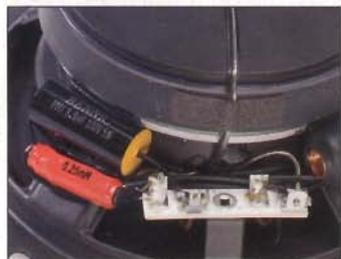
**Powerstoff:** Die teils hochwertigen Weichenbauteile kleben ganz einfach neben dem Terminal am Korb – simpel, aber wirkungsvoll.
