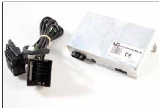
**Idiotensicher:** Mit dem fertig konfektionierten Kabelsatz ist die Verstärker-Blackbox des UG VW-GOLF 5-F mit integriertem Prozessor im Handumdrehen angeschlossen.
