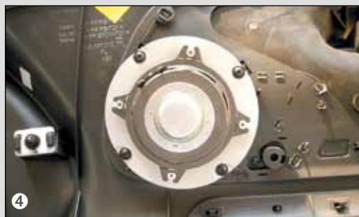
Bergfest: Die größte Anstrengung ist das Aufbohren der Nieten des Tieftöners, danach geht's an den relativ einfachen Einbau.
