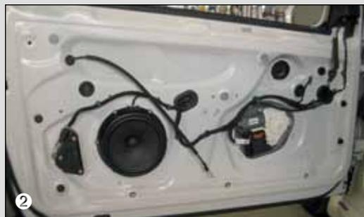
1-2-3-frei: Der Werkshochtöner ist mit drei Plastikführungsfasern verschweißt; man entfernt ihn einfach mit einem kleinen Messer.
