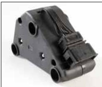
**Klon:** Die Weiche des UG VW-GOLF 5-F steckt in einem Gehäuse mit gleichem Stecker und gleicher Befestigung wie beim VW-Original.
