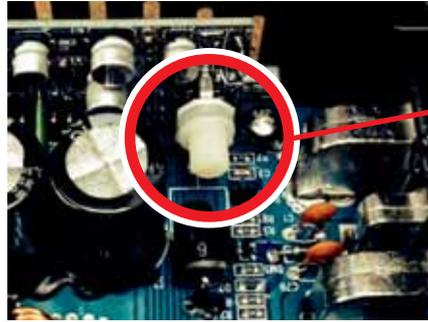
Über Potentiometer (roter Kreis) kann die Empfindlichkeit der Signalerkennung stufenlos eingestellt werden.
